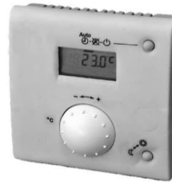
Raumgerät QAA50.110/101 , mit LCD-Anzeige, Raumtemperaturmessung und -anzeige, Drehknopf zur manuellen Sollwertkorrektur, Betriebsart- und Präsenztaste
